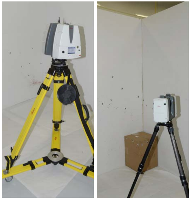
Rysunek 2: Skanowanie na stanowisku przeprowadzono za pomocą Leica ScanStation P40 i Leica RTC360.
